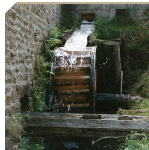
La roue du moulin en septembre 1992. Joseph Desriac la changea en 1974. Sur les petites rivières comme le Léry, on utilisait souvent une chute d'eau qui entraînait une roue à godets.
